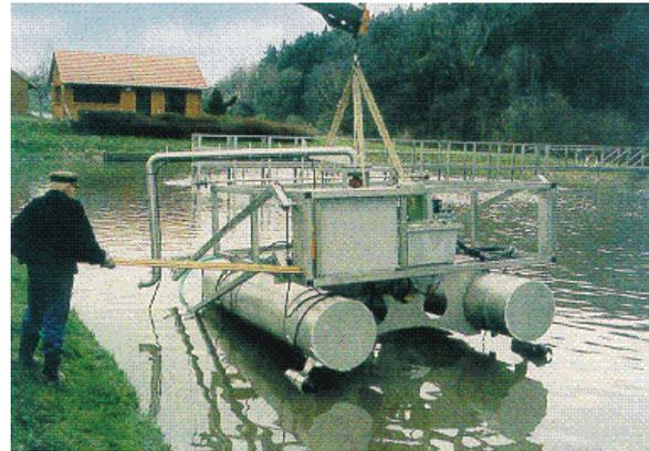
Abb.: 18 Schlammräumung nach Trockenlegung des Teiches (links) und Schlammräumung mit schwimmendem Bodenräumer (rechts) [23]
