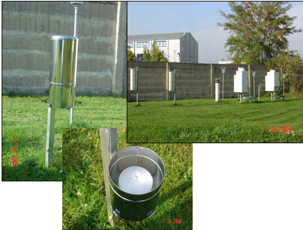
Abbildung 86: Niederschlagsmesser nach Hellmann (Standort Halle Ost)
