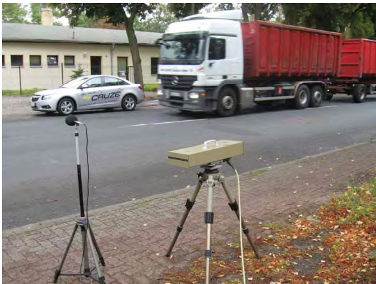
Abbildung 100: Messung der Verkehrsgeräusche nach DIN EN ISO 11 819/1
