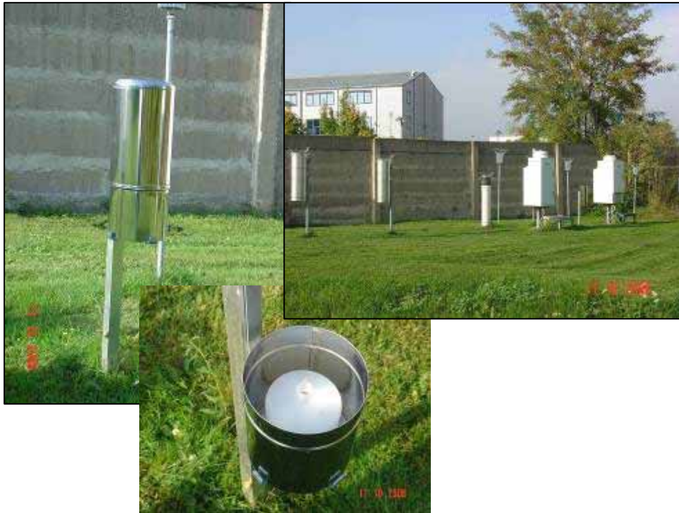
Abbildung 80: Niederschlagsmesser nach Hellmann (Standort Halle Ost)
