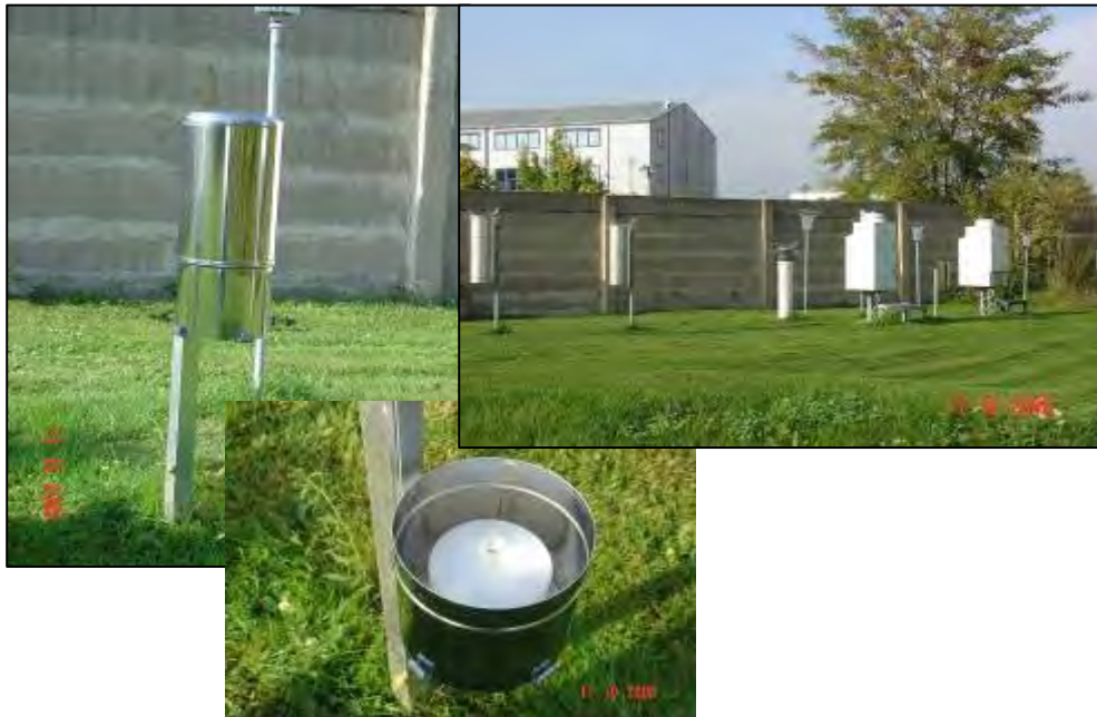
Abbildung 40: Niederschlagsmesser nach Hellmann [Standort Halle (Ost)]
