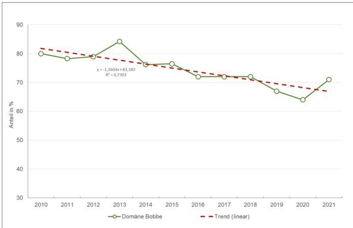
**Abbildung 24: Entwicklung des Anteils vom  $\text{PM}_{2,5}$  am  $\text{PM}_{10}$  am Beispiel einer Messstation im ländlichen Hintergrund (Domäne Bobbe)**
