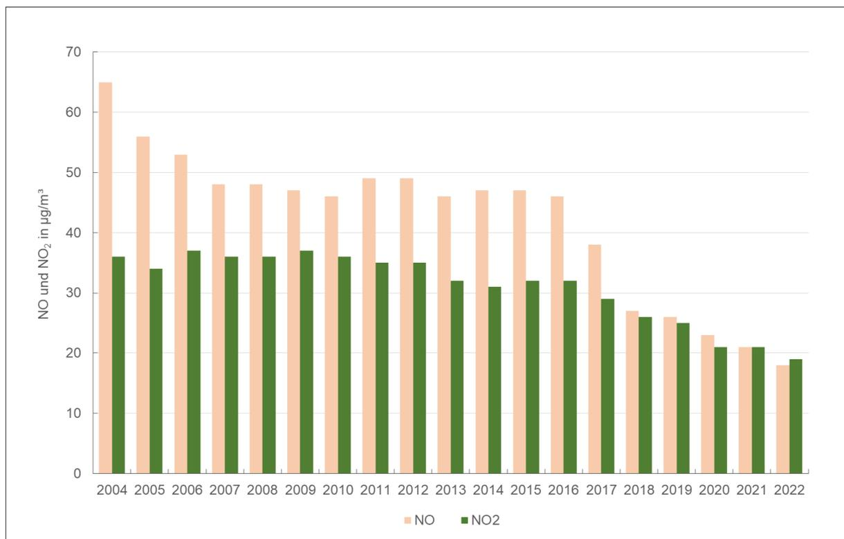
**Abbildung 10: Jahresmittelwerte NO und  $\text{NO}_2$  an der Verkehrsmessstation Wittenberg/Dessauer Straße**
