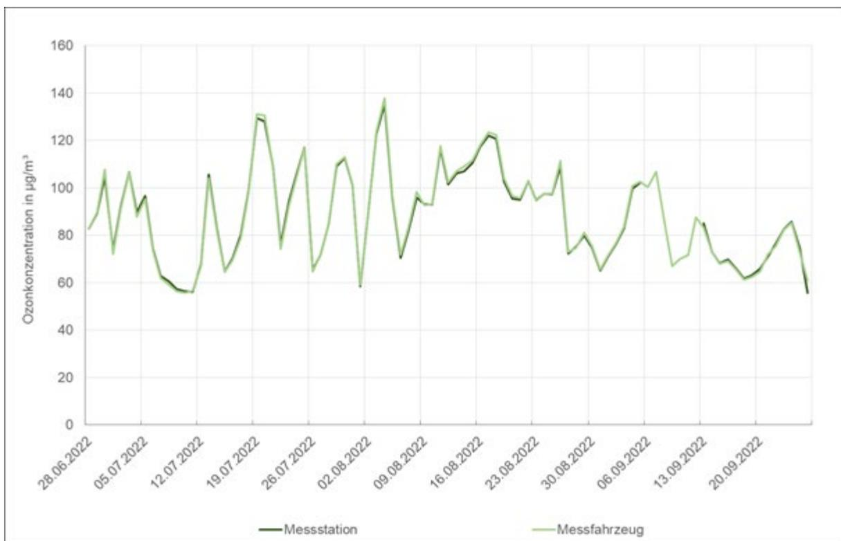
Abbildung 57: Tagesmittelwerte der Ozonkonzentration im zeitlichen Verlauf für das Messfahrzeug und die Messstation auf dem Brocken.
