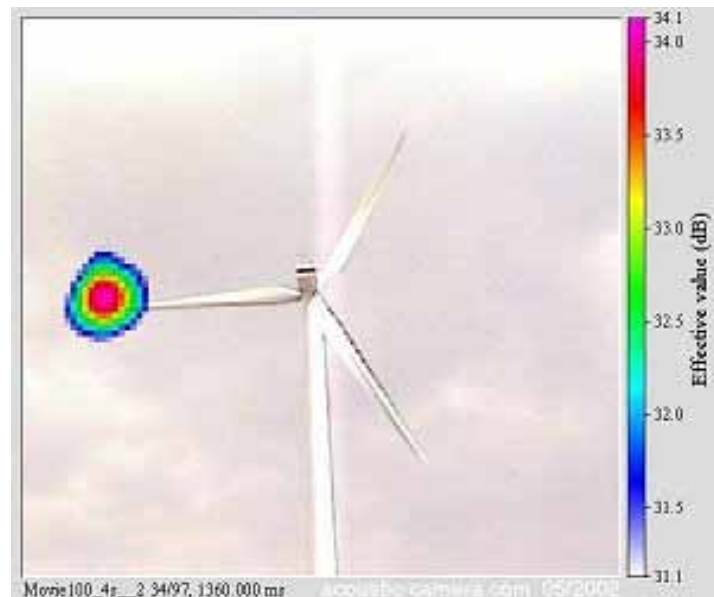
Abbildung 4.1.10: WEA mit akustischer Kamera aufgezeichnet (Quelle: Firma GFAI)
