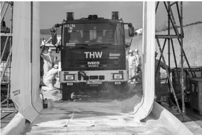
Die Kameraden des THW-Ortsverbandes Quedlinburg stellten eine Dekontaminationsanlage für LKW vor und betrieben diese probeweise für das Fachpublikum. Parallel dazu hatte die Feuerwehr Cattenstedt eine Personendekontamination aufgebaut.
